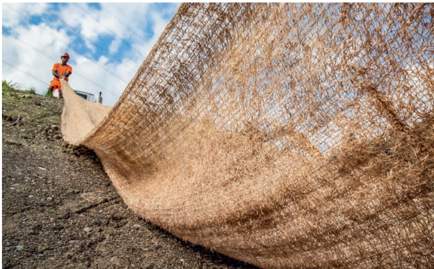
Die Erosionsschutzvliese werden in acht Typen angeboten. Sie sind einfach zu verlegen, stabilisieren hängiges Gelände und ermöglichen ein ideales Mikroklima. Da das Vlies nur Naturfasern enthält, muss es auch bei eventuellem Rückbau nicht vom Aushub getrennt werden. Foto: Lindner Suisse
